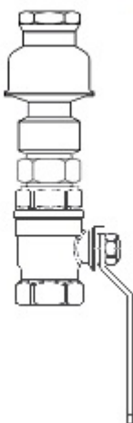
Воздушный вентиль в сборе с шаровым краном
